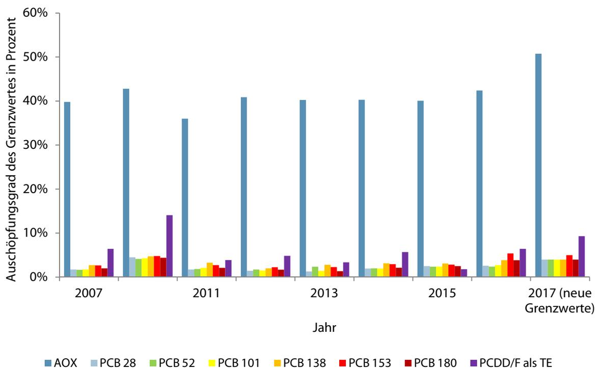
Abbildung 3-3: Ausschöpfungsgrad der der Grenzwerte von weiteren Schadstoffen im Klärschlamm in M-V
