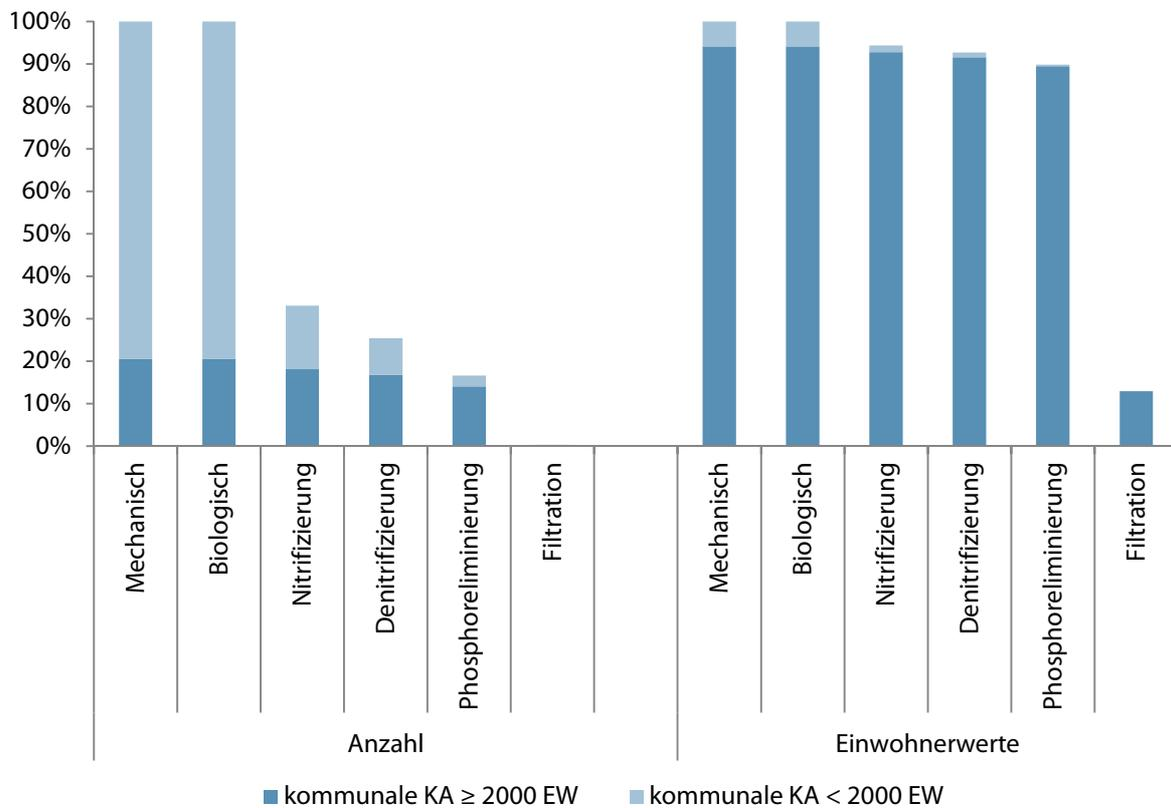
Abbildung 2-4: Ausbaugrad und Reinigungskapazität der kommunalen Kläranlagen
