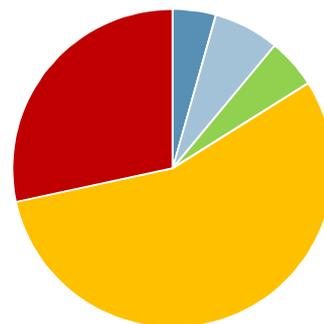
Deutlich zu sehen ist, dass die relativ große Anzahl (91,3 %) kleiner Anlagen (bis zu 10.000 EW) nur einen sehr geringen Anteil (16,0 %) des Abwassers reinigen, während sehr wenige (8,7 %) große Anlagen (über 10.000 EW) den überwiegenden Anteil (84,0 %) behandeln. Folglich ist die technische Ausrüstung und Reinigungsleistung dieser relativ wenigen großen Anlagen von zentraler Bedeutung für die Wasserqualität in Mecklenburg-Vorpommern.
